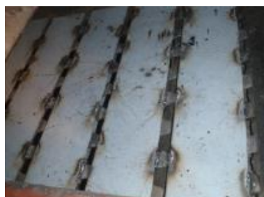
改善前（左） フィンガースクリーンの隙間から残差が落ちる 改善後（右） 穴から細かい残差が落ちる
