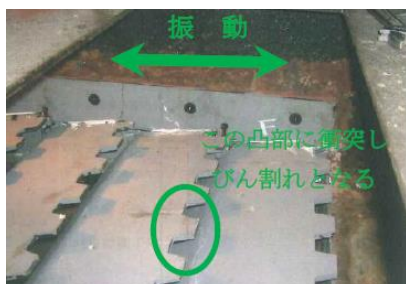
改善前（左） フィンガースクリーンの隙間から残差が落ちる 改善後（右） 穴から細かい残差が落ちる
