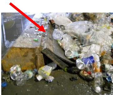
受け入れ投入部にスロープ状のクッションを設置 ①
