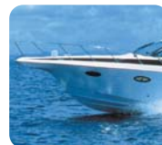
FRP製ボート (グラスファイバー強化プラスチック材)
