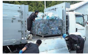
金網カゴ使用で輸送時の破損軽減と効率化
