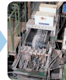
⑦ 金属選別 細かい金属類を探知機で除去
