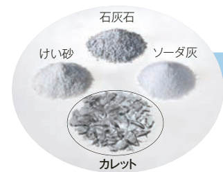
① 原料・調合 けい砂・石灰石・ソーダ灰などの天然素材とカレットを、ミキサーで均一な状態になるまで混ぜ合わせます。
