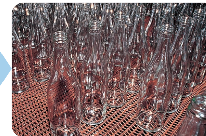
⑤ 徐冷 熱を持っている成形直後のガラスびんを急に冷やすと割れやすいため、徐冷炉で少しずつ冷やしていきます。
