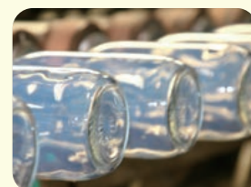
コーティング ガラスびんメーカー独自のコーティング技術で、いろいろな色をつけたり強度を増したりします。
