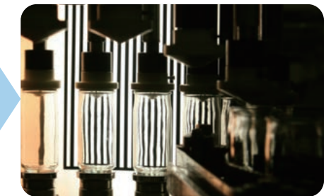
⑥ 検査 確かな品質のガラスびんを送り出すために、強度や傷を高精度の検査機や人の目で厳しくチェックします。
