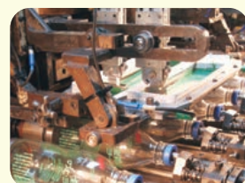
印刷 びんの表面にガラスと同じ成分のインキを刷り、約600℃の温度で焼き付けます。
