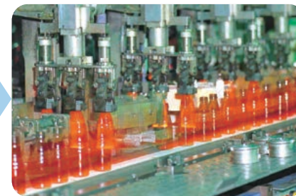
④ 成形 ゴブを金型に入れてびんの形にします。いつ・どこでつくられたのか、びんの底にマークがつけます。
