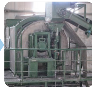
② ラベル剥離 ガラス片に付いているラベルを剥がす
