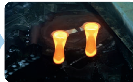
③ ゴブ(ガラスの塊) 溶かしたガラスから、びんを作るのに必要な量だけ切り取り、製びん機に送ります。その塊をゴブと言います。
