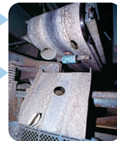
④ 磁気選別 磁気によりキャップや鉄類を除去
