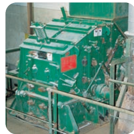
① 破碎 空きびんを細かくガラス片に砕く
